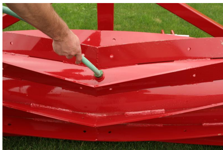
شکل ۴- نمونه‌ای از کوبنده دوار (Roller crimper) که جهت افزایش وزن با آب پُر می‌شود.
