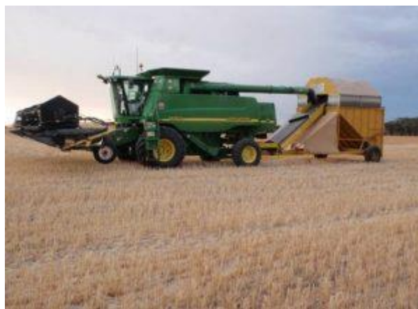
شکل ۱- گاری جمع‌کننده کاه و کلش (Chaff cart) که بدنبال کمباین وصل شده است.
